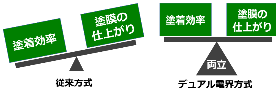
図8 塗膜の仕上がりと塗着効率の関係
