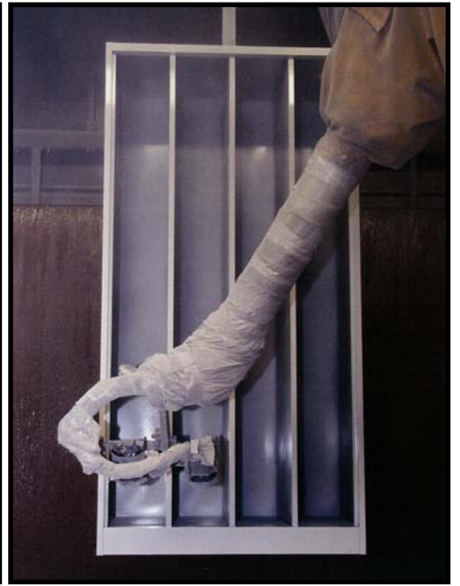
▲被塗物内面を塗装するロボット塗装機 (AF33)、ガンはエアスプレー自動ガン AG32S を装着
