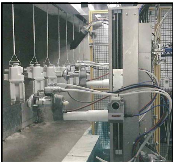
▲自動静電塗装:回転霧化静電自動ガン 2 丁 (ガンは、ESA88) 静電自動ガン 1 丁 (ガンは、EAB400)
