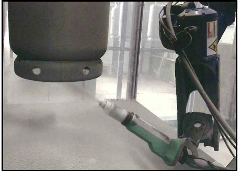
▲ロボットによる粉体塗装、ガンはECXaを装着する
