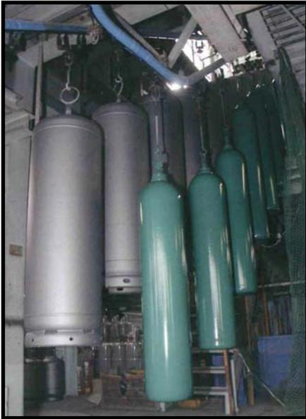
▲LP ガス容器(左)と一般高圧ガス容器(右)が同時に塗装可能な粉体塗装ライン
