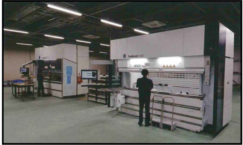
▲高精度な薄板の曲げ加工機
