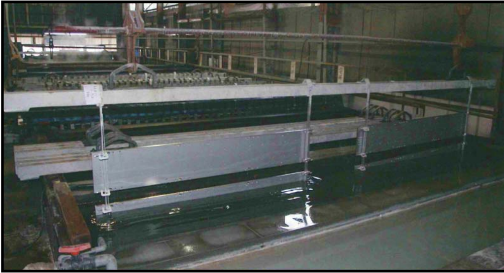
▲アルマイト処理槽 写真は水洗槽へ浸漬(しんせき)される部材
