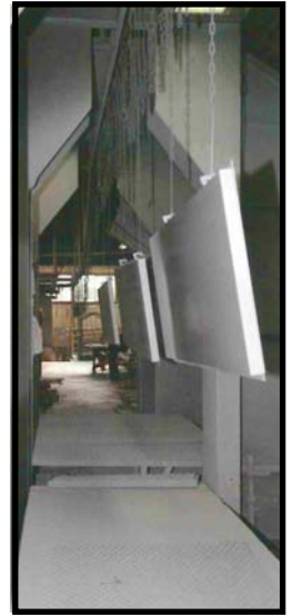
▲自動塗装ブースへ進行するワーク
