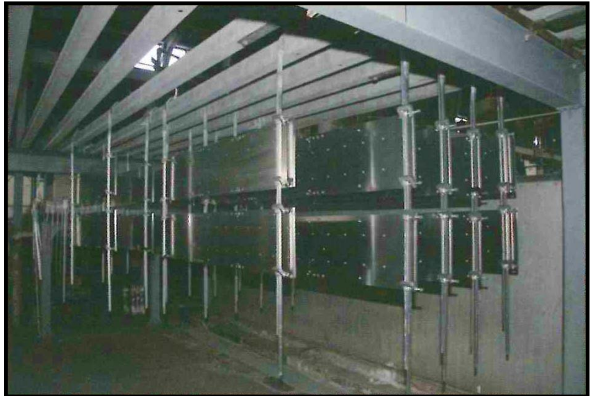
▲アルマイト処理槽へ入る前のアルミニウム製の部材
