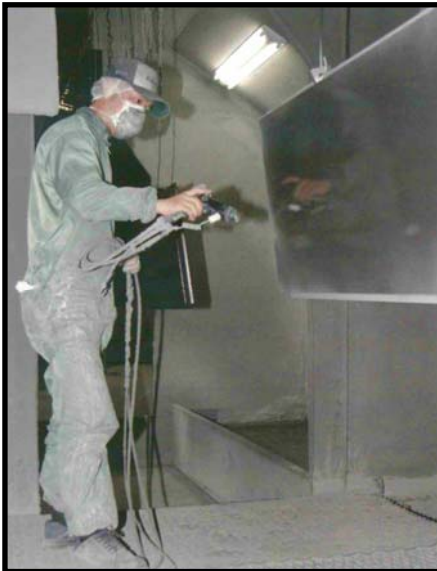
▲エア静電ハンドガンHBシリーズによる上塗りの補正塗装
