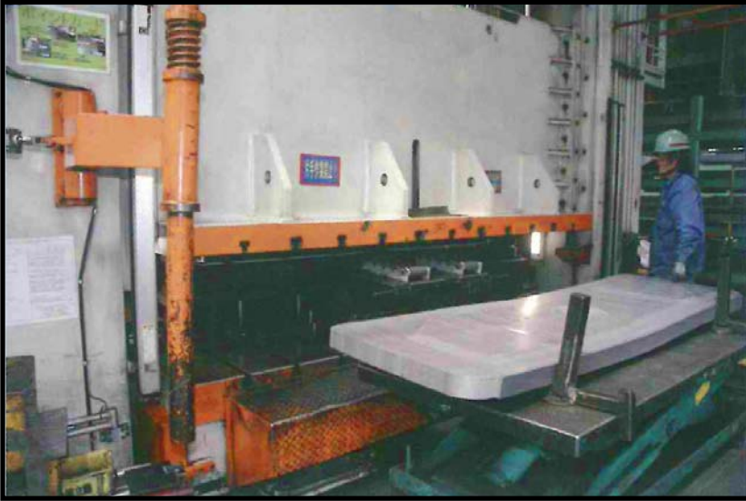
▲絞り加工(鉄板に凹凸をつける)
