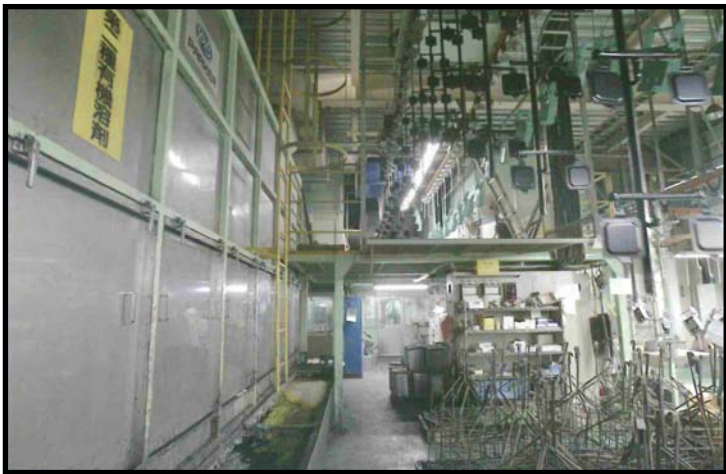
▲焼き付け乾燥炉へと進行するワーク
