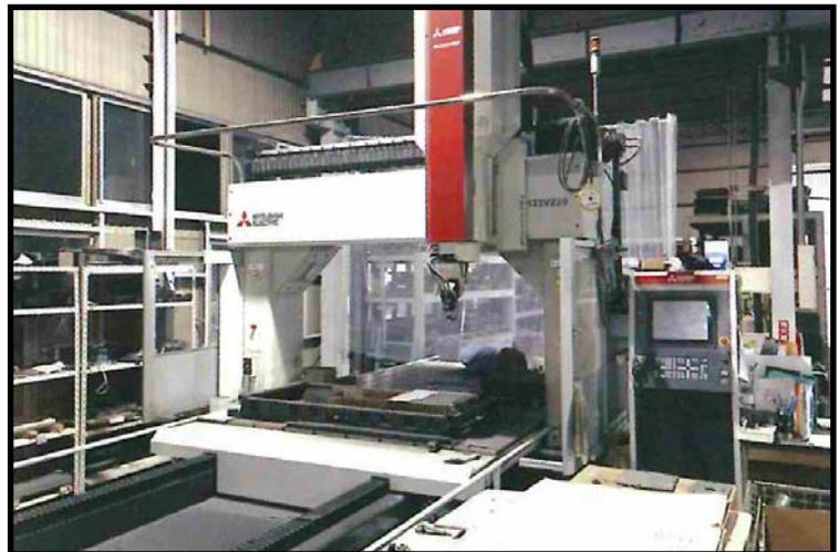
▲板金加工 三次元レーザ加工機
