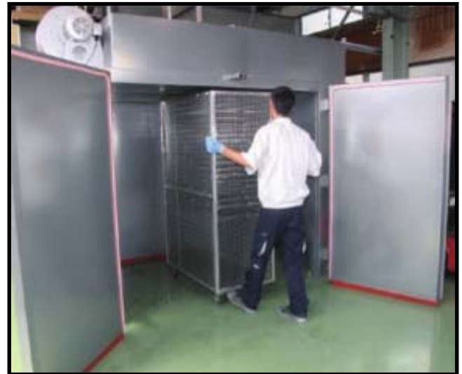
▲固定炉からワークを搬出
