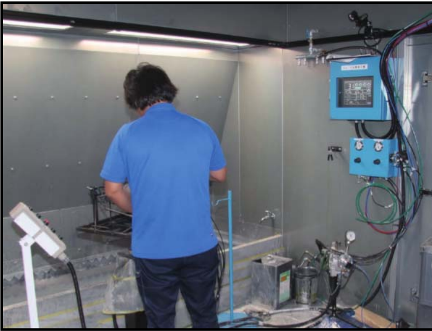
▲ロボットティーチング支援システム 「スプレイトレーサ」の全容
