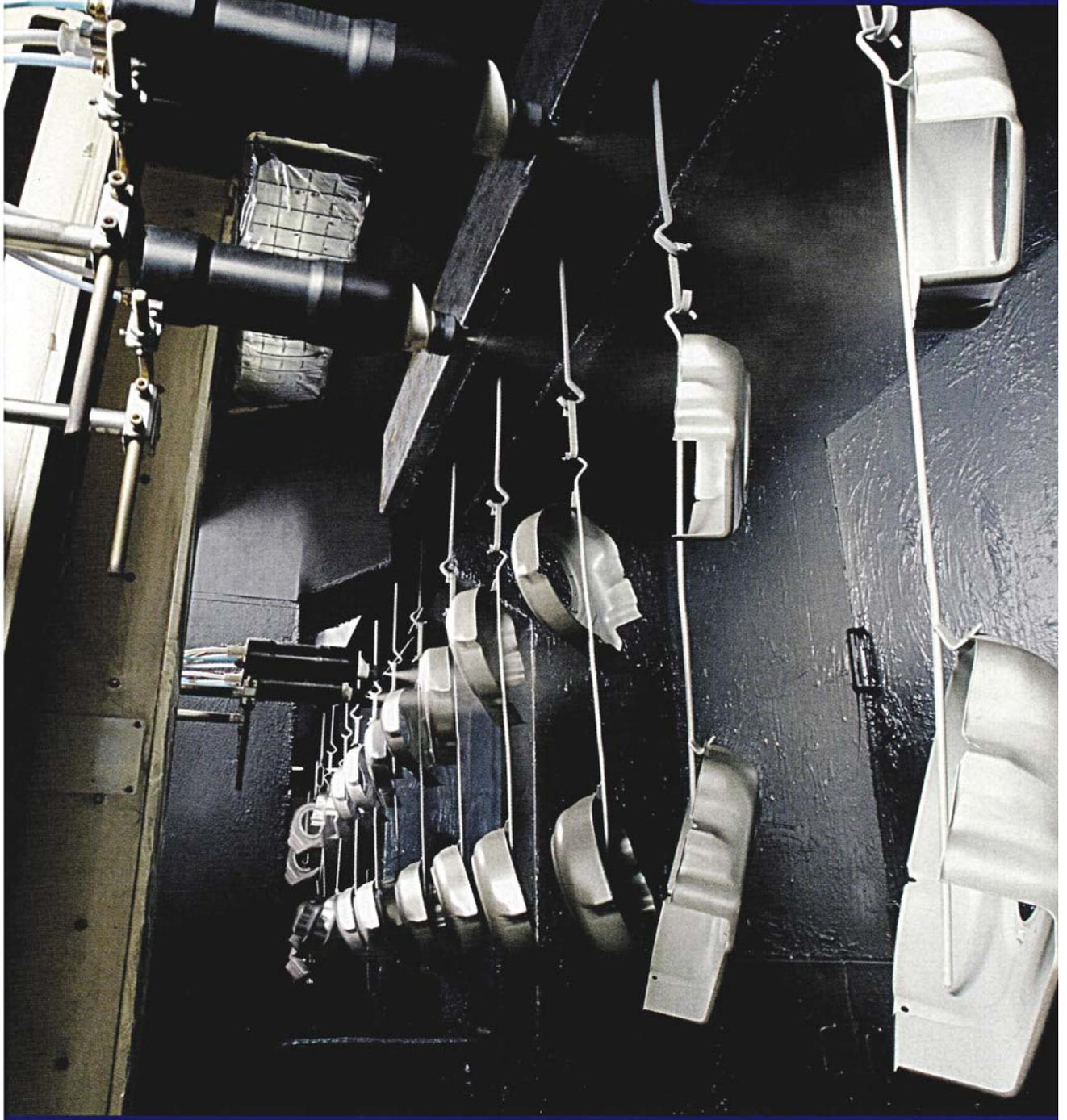
スマートサナックシステムによる農機具の静電塗装
