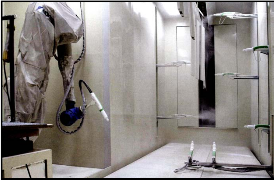
▲塗装システム：平面ワークは1レシプロ2ガン×2基(対面式), 箱物ワークは1レシプロ2ガン(側面)+2ガン(底面・昇降可能)+ロボット1ガン(内面)で塗装する。ガンはX-3aを装着する。
