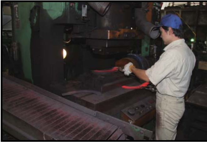
▲切断したスプリング鋼材に約 1200℃の熱を加えて耕うん爪の大まかな形に成型する
