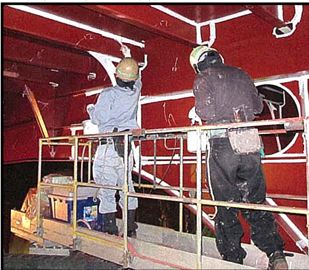
▼ファーストコート後のストライプコート (穴, コバ, シーム) 施工
