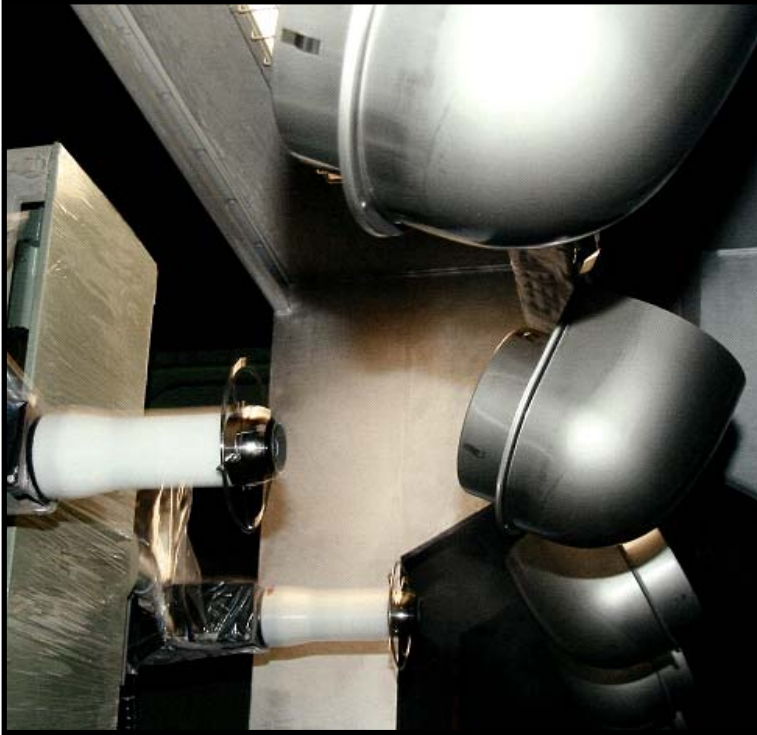
▲新設の自動静电塗装システム(1レシプロ2ガン) ガンは高速回転霧化静电自动ガン(サンベル ESA120)
