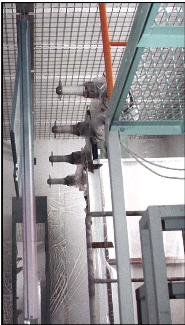
▲中塗り塗装ブース(2基連結) 1レシ4ガン×2基(高速回転霧化静電自動ガン サンベル ESA120)
