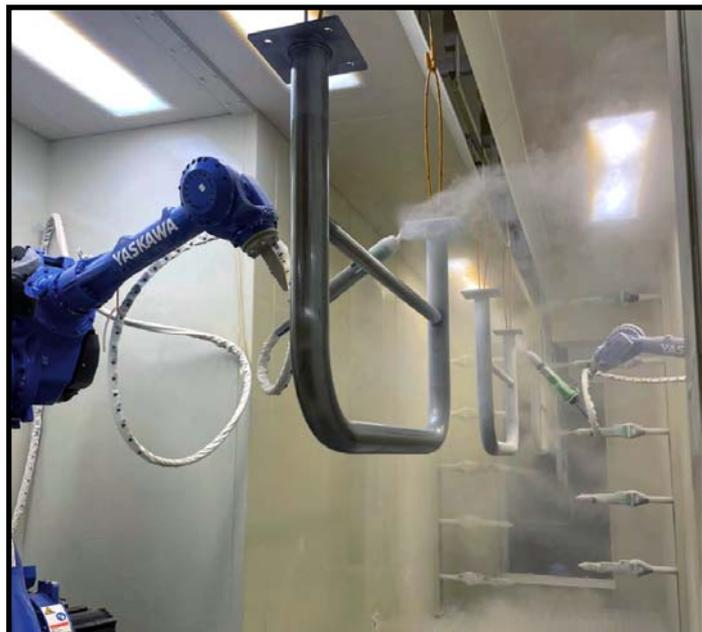
▲1ブース当たり、塗装ロボットが2式(前補正のタッチアップ用)と1レシプロ5ガン×2基(対面式)、ガンは計12ガン(2ブースで計24ガン)で、デュアル電界方式粉体自動ガン(ECXa)を装着する
