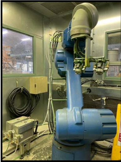
▲ガンは高塗着エアスプレー 自動ガン AGB50 を2基装着 する
