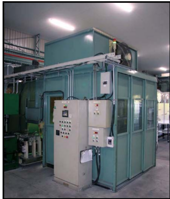
▲有圧換気扇でゴミ・臭気対策が 万全なロボット塗装ブース
