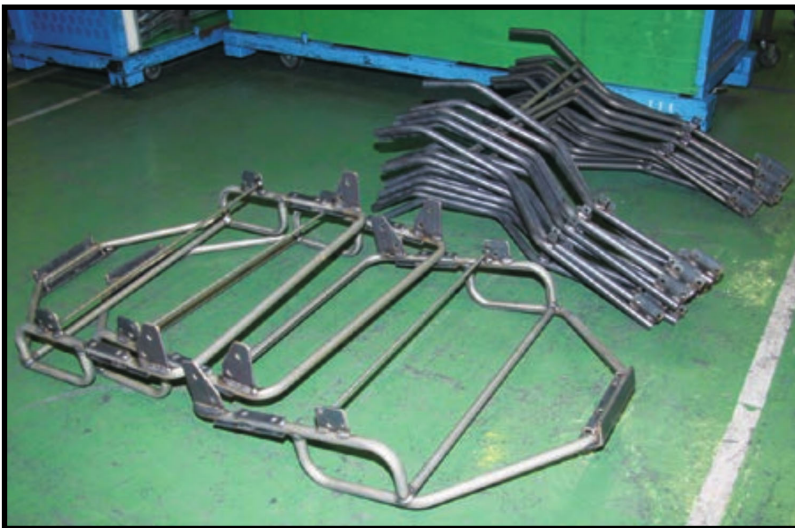
▲塗装前の金属製品(ゴルフボール回収装置の架台)
