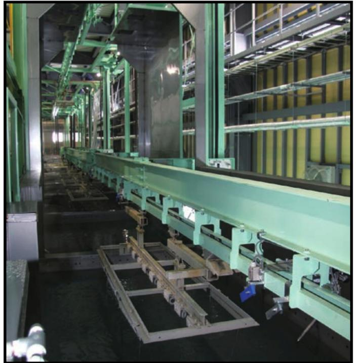
▲前処理工程はディップとスプレー方式を併用する
