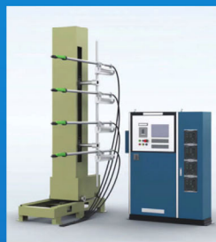
粉体3D形状認識 塗装システム 省人化と生産効率の向上
