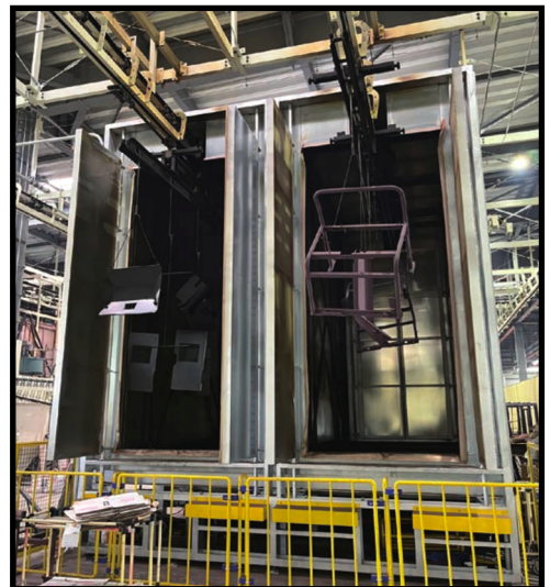
▲焼き付け乾燥炉(右:上塗り用の入口, 左:下塗り用の出口)
