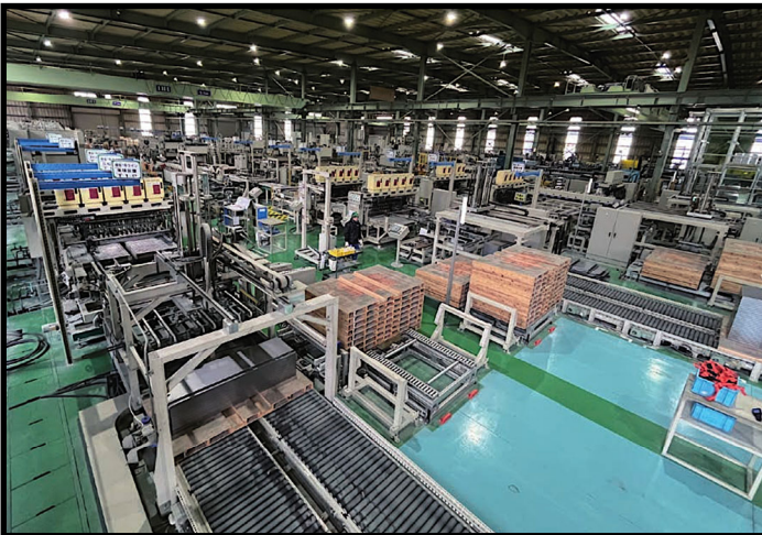
▲棚板の板金・溶接自動加工ライン
