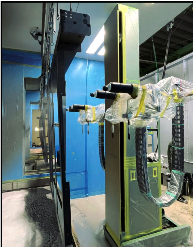
▲新規塗装システムは、1 レシプロ 4 ガン、 ガンはエア静電自動ガン EAB500 を装着する
