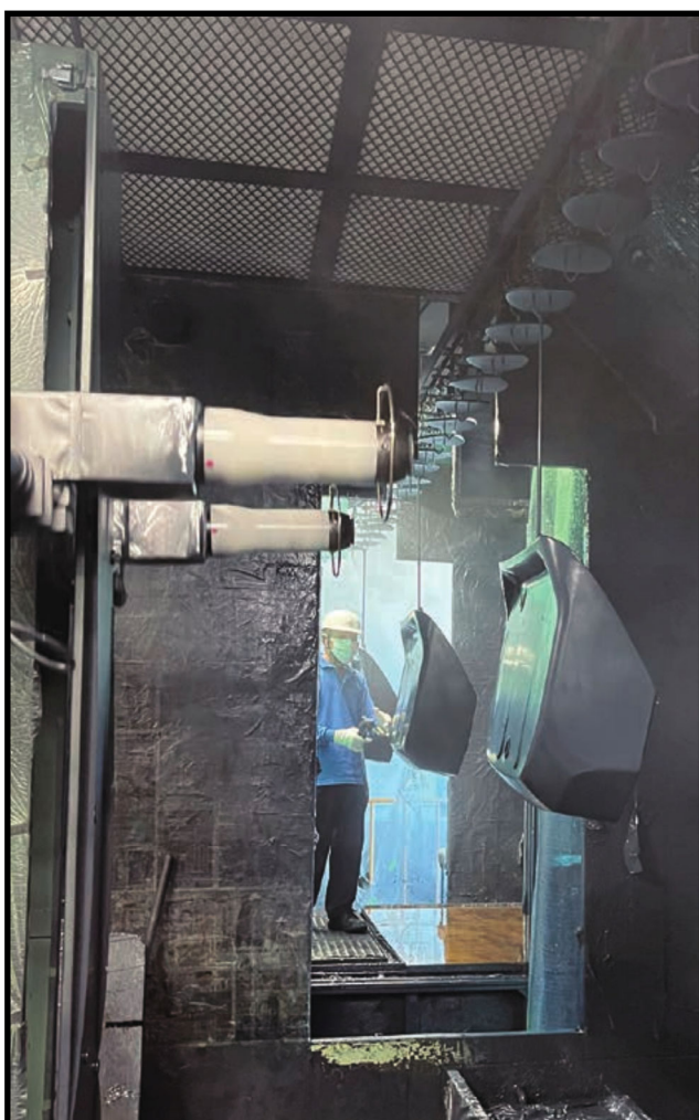
▲第1 塗装ブースは、1 レシプロ 2 ガン、 ガンは高速回転霧化静電自動ガン ESA120 を装着する
