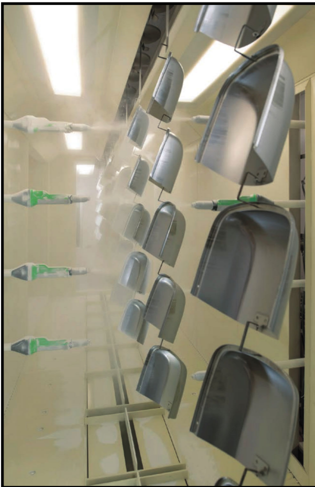
▲粉体塗装は無人化を実現 塗装システムは、1 レシプロ 4 ガン×2 基 (対面式)、ガンはデュアル電界方式静電 粉体自動ガン Ec' Corona-X・ECXa を装着する。
