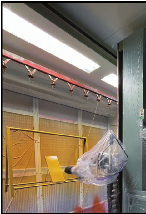
▲ 塗装制御はワーク形状に合わせて スプレーカットするレシプロ制御 を採用
