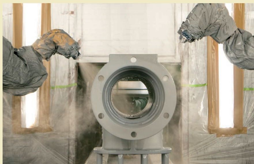
水性塗装システムは、 塗装ロボット2基に封孔処理剤用の エアラップ自動ガン・AGA10と、水 性塗料用の高塗着エアスプレー自動 ガン・AGB51がそれぞれ1ガン装着 されている(いずれも非静電タイプ)
