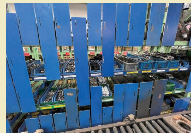
バルブ本体の組立では、製品のバーコードリーダーを読み取る と組立に必要な部品のケース部が開き、使用しない部品のケー ス部は青いパネルで塞がれるように工夫されている
