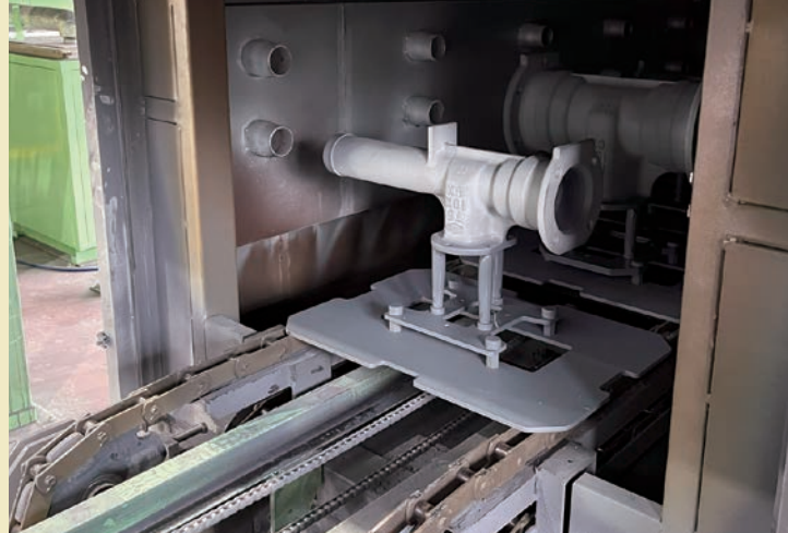
粉体塗膜の強度確保と 水性塗装に向けて物温度を均一にするための後加熱
