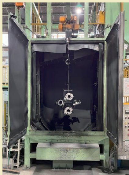
グリッドブラストを終えて溶射工程へ進行
