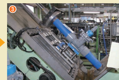
バルブ本体の組立では、製品のバーコードリーダーを読み取る と組立に必要な部品のケース部が開き、使用しない部品のケー ス部は青いパネルで塞がれるように工夫されている
