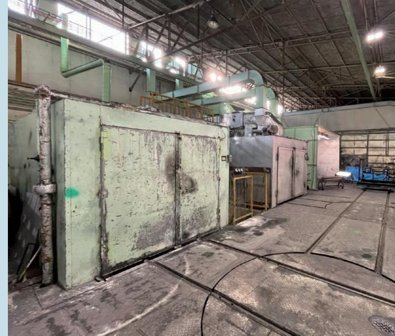
大型フレーム専用の塗装場(手前から前処理、バッチ炉、塗装ブース)
