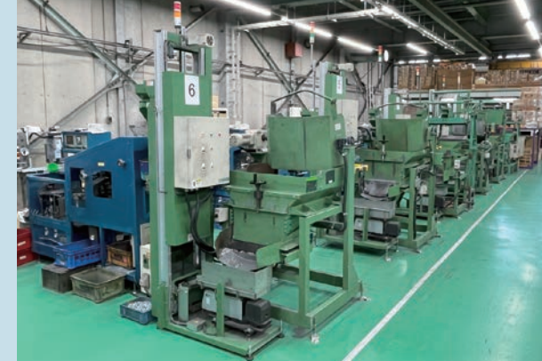
ネジの品質を検査するネジ選別機(画像認識/センサー認識)
