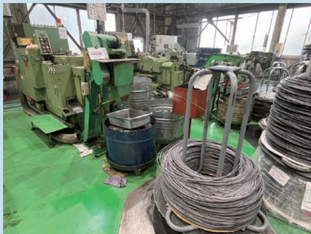
ネジ頭を加工するヘッダー加工機
