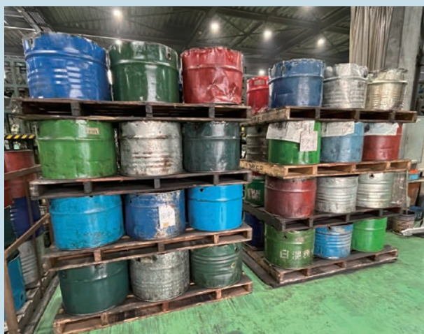
成型加工を終えた大量のネジは、熱処理→電気亜鉛メッキ→三価クロメート処理を行うため、加工専門業者へと送られる
