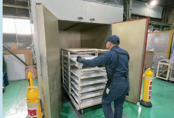
焼き付け乾燥には電気炉を使用
