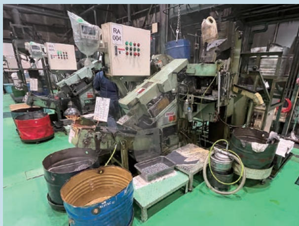
ネジ部(らせん状)を加工するローリング加工機
