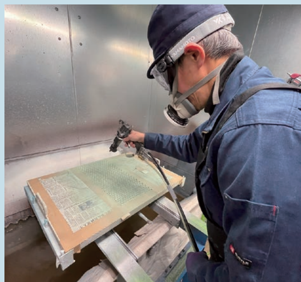
手吹き塗装にはエア静電ハンドガンHB5000を使用する
