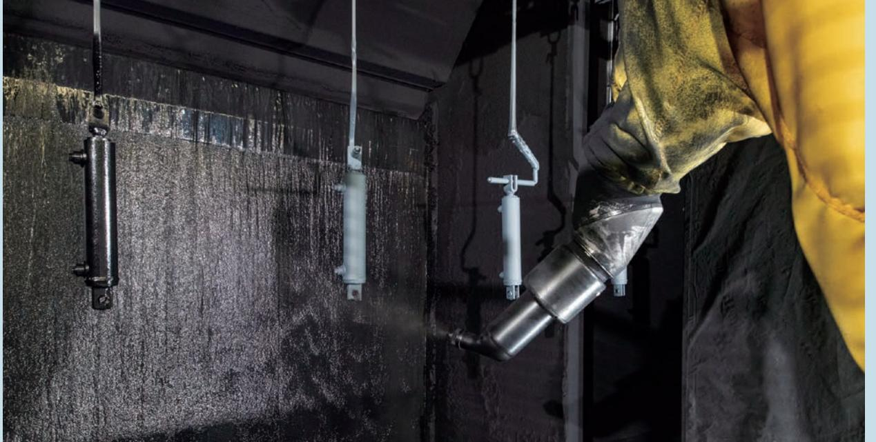
上塗り塗装も下塗りと同じロボット塗装システム・エア静電自動ガン(EAB400R)が使用されている
