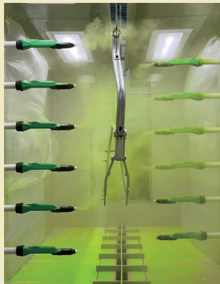
下塗り(本塗装)のシステムは、1レシプロ6ガン×2基(対面式)で、自動ガンには最新のデュアル電界方式静電粉体自動ガンEcoDual・ECDaを装着する
