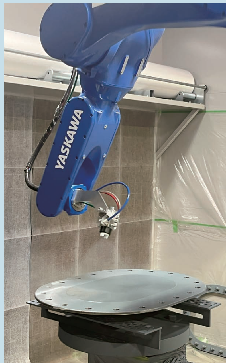
塗装ロボットにはエアラップ自動ガンAGA10が装着されている
