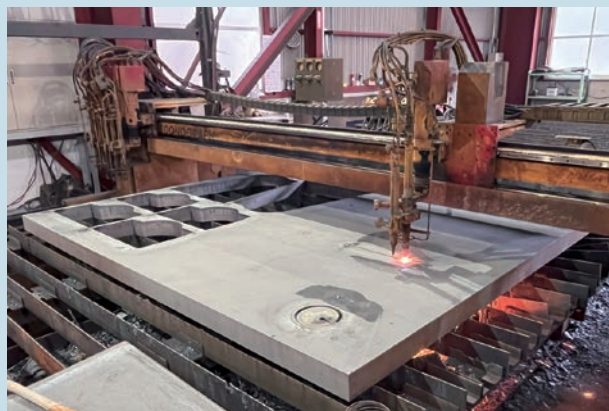
ガス切断機で90mm厚の鋼材を型抜き
