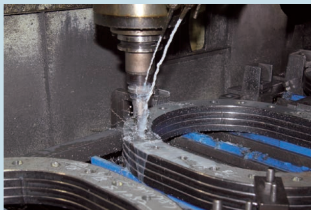
座(コーミング)部へのネジ穴加工
