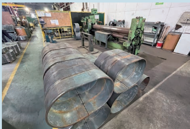
ベンディングロールによる曲げ加工
