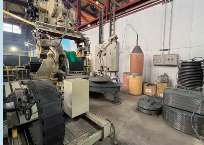
溶接ロボットによるカバー(蓋)部への印字(ビード)加工
