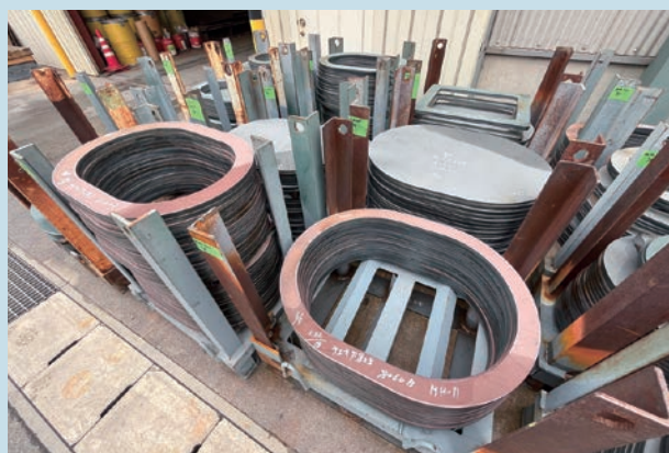
切断加工を終えたマンホール
