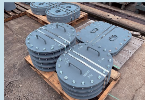
座にカバーを取り付けて完成
