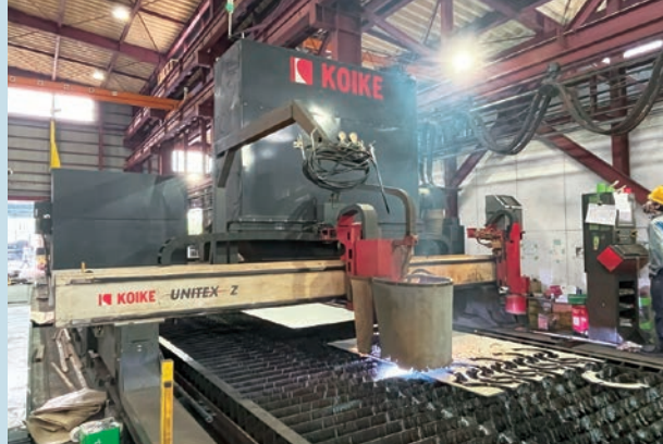
プラズマ切断機でマンホール形状に型抜き
