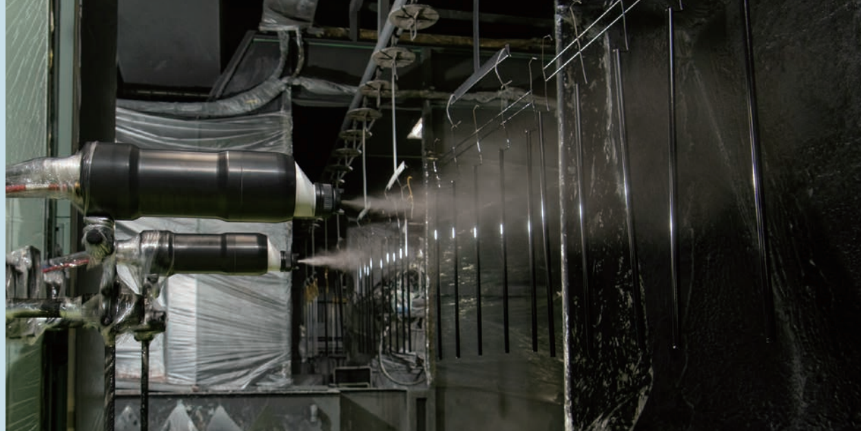
塗装システムは、1レシプロ2ガン×2基、ガンはエア静電自動ガン・サンガンⅢ (EAB500) を装着する
