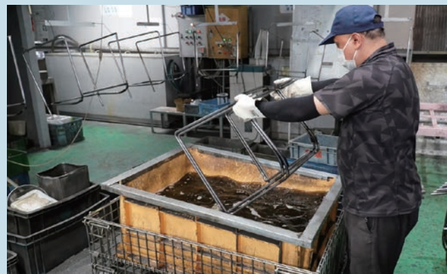
塗装ライン着荷前にパイプ内の油抜きを行う
