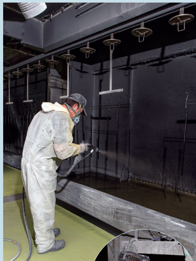
手吹きおよび補正塗装
