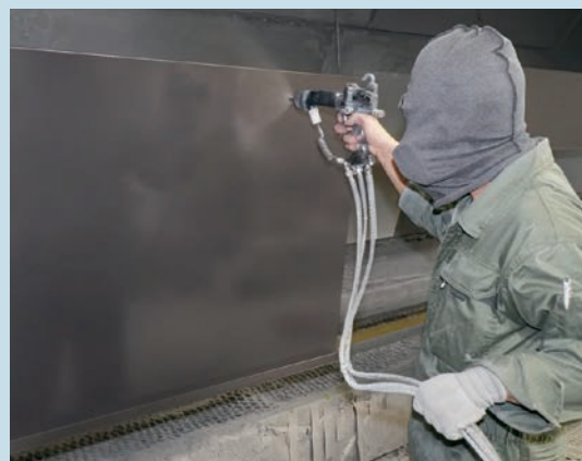
上塗り塗装には、 エア静電ハンドガンHB5000Mを使用する
