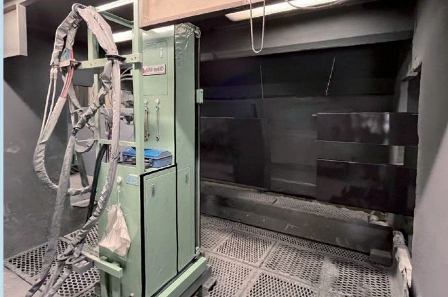
レシプロ塗装機が導入された 中塗り塗装ブース
