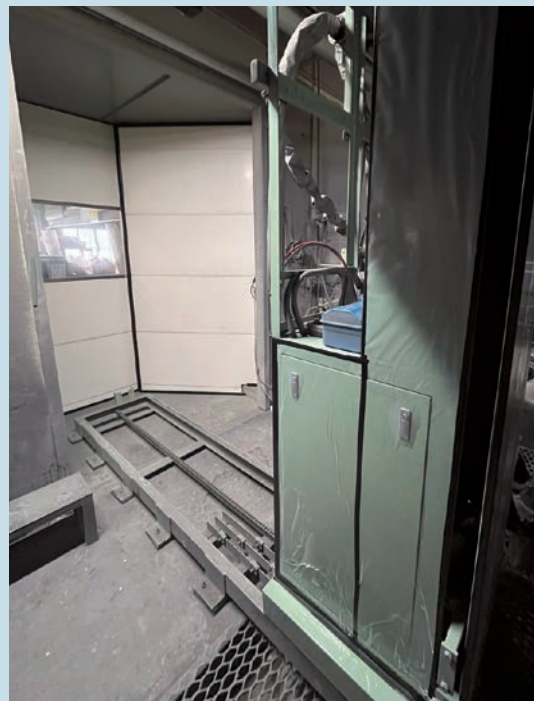
手吹き塗装がしやすいようにレシプロが前後進する
