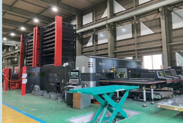
ファイバーレーザー複合機で板金加工の効率化を図る
