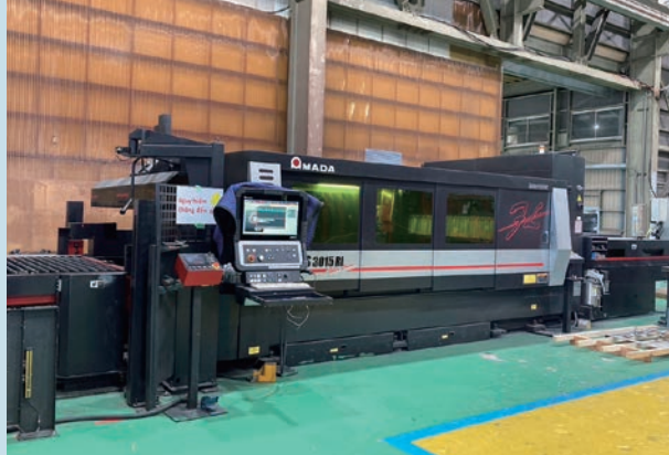
平板、パイプ、形鋼を加工できるファイバーレーザーマシン
