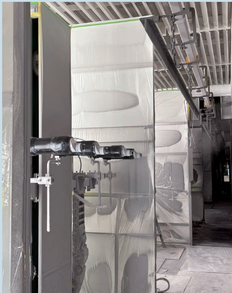
下塗り塗装システムは、1レシプロ4ガン、自動ガンはエア静電自動ガン・サンガンⅢ (EAB500) を装着する
