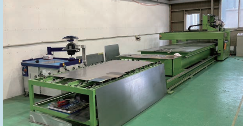
鉄素材にヘアライン模様をつけることができるバイブレーション研磨機
