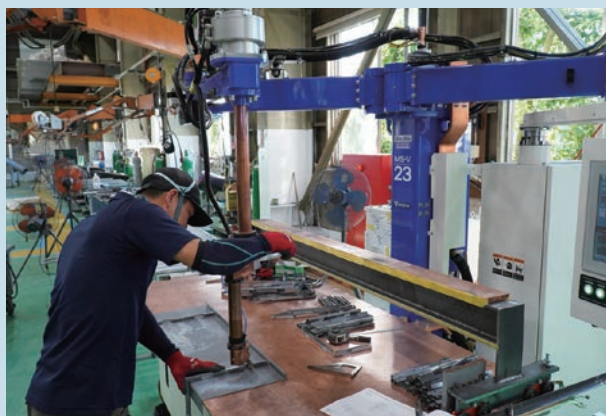
スポット溶接(半自動機)
