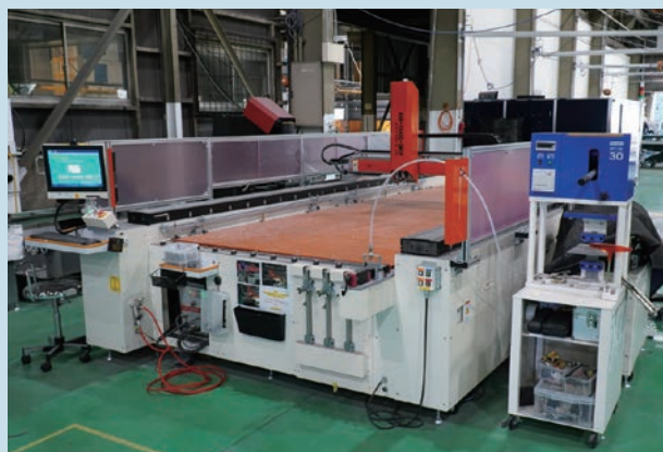
10mm径までのスタッドを高速で安定溶接が可能
