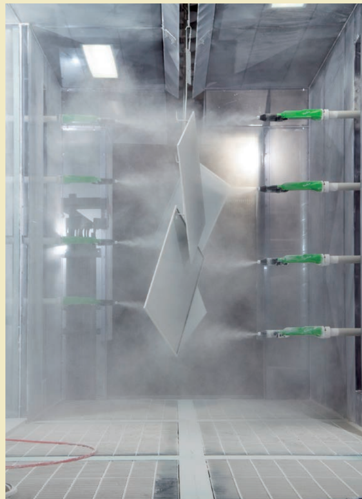
新たに導入された粉体塗装システムは、1レシプロ4ガン×2基(対面式)で、自動ガンにはデュアル電界方式静電粉体自動ガンEcoDual・ECDaを装着する
