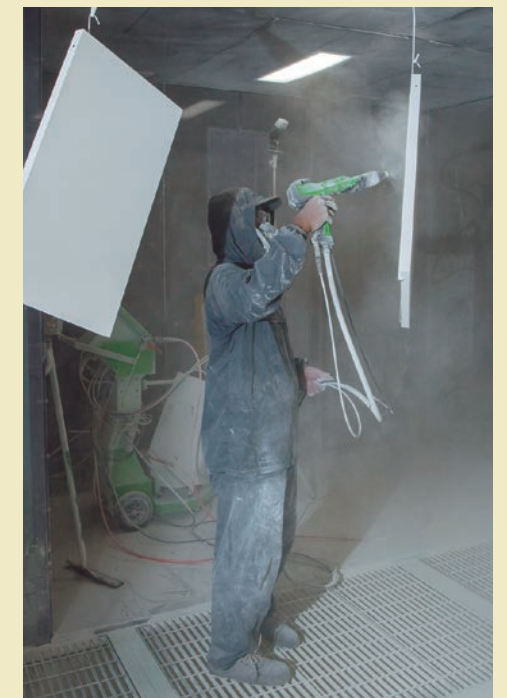
補正は、デュアル電界方式静電粉体ハンドガンユニットEcoDualを使用
