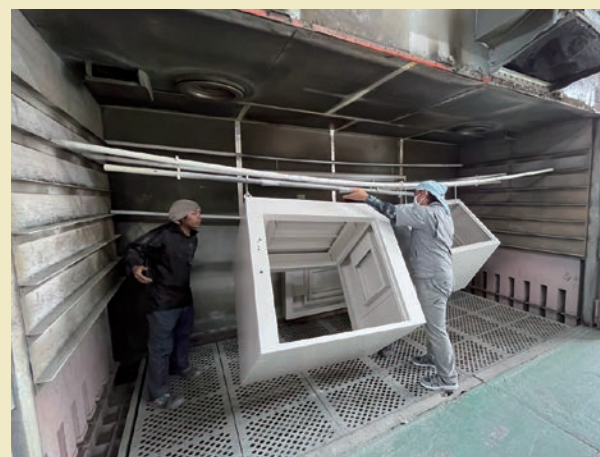
第二工場 重量物の焼き付け乾燥
