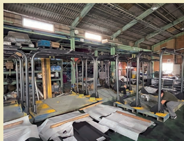
塗装前の機械式駐車場部材
