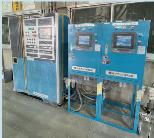
塗装制御盤 (SUNAC 1000EX) (左) と 多液用二液混合装置 (ACW4000EX)
