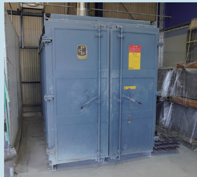
熱分解式剥離炉による塗装ジグ剥離
