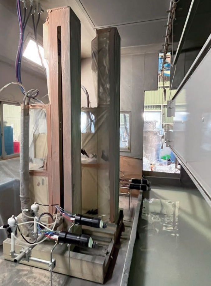
塗装制御盤 (SUNAC 1000EX) (左) と 多液用二液混合装置 (ACW4000EX)
