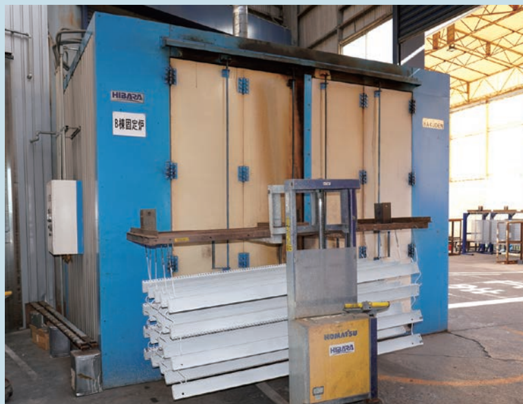
前処理水切り／電着塗装乾燥炉
