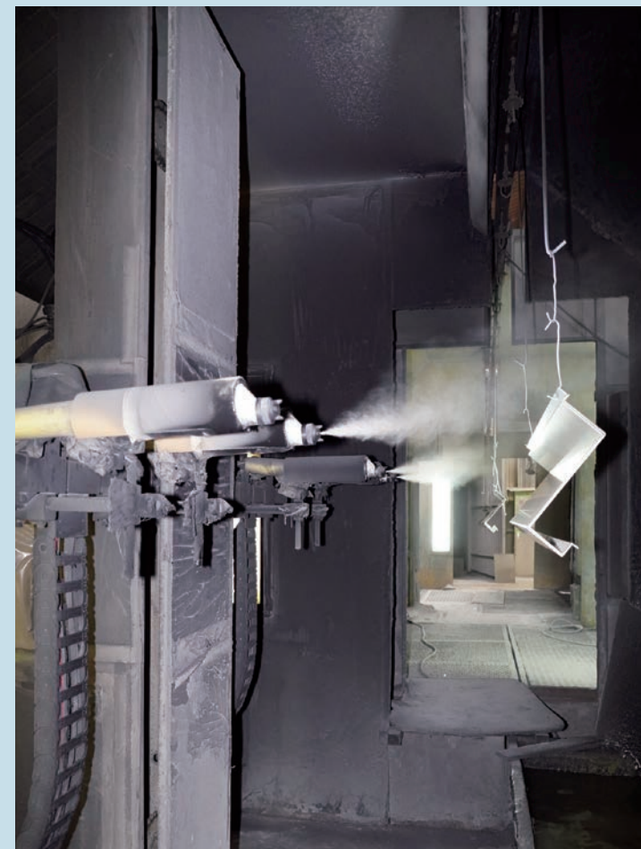
南塗装ラインの上塗りも北塗装ライン同様にレシプロと自動ガンを更新
