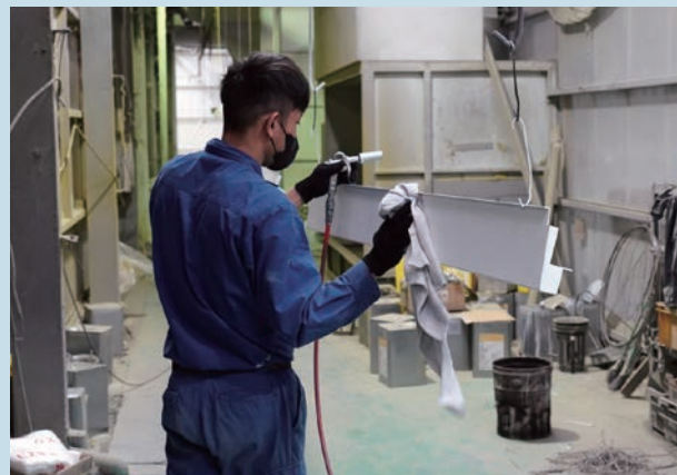
北塗装ラインでの塗装前のエアブロー
