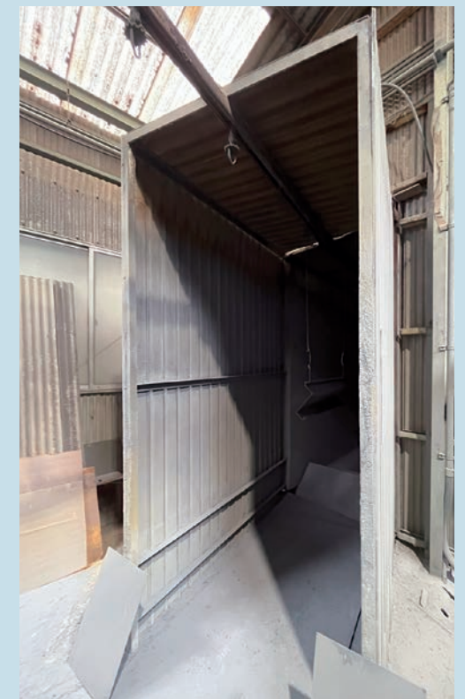
南塗装ラインの焼き付け乾燥炉
