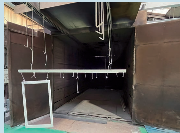
大型ワークの乾燥はバッチ炉で対応
