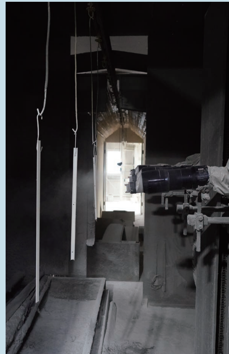
北塗装ラインの上塗り塗装では、レスプロと自動ガンを更新 自動ガンはエア静電自動ガン・サンガンⅢ(EAB500)を装着する
