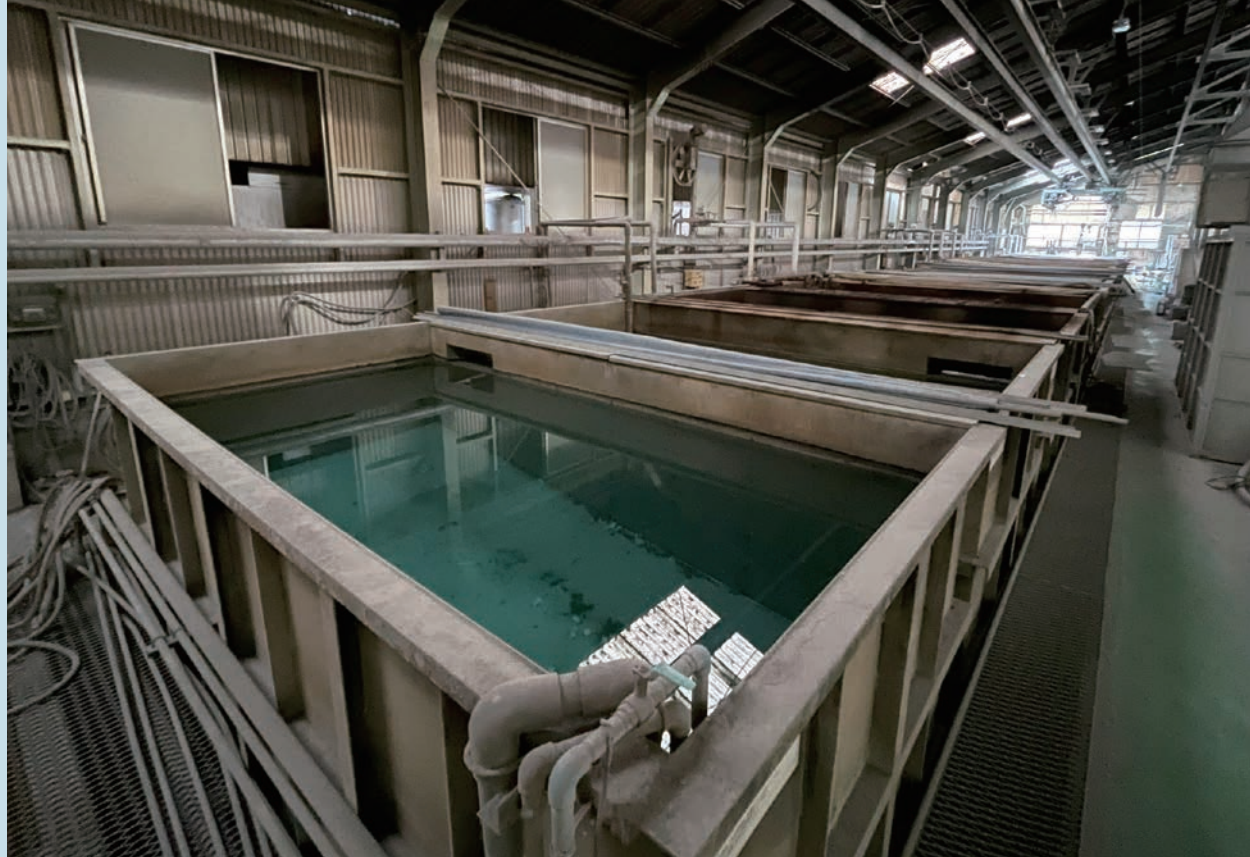
前処理装置(リン酸亜鉛化成皮膜処理／アルミ素材用の六価クロム酸クロメート処理)
