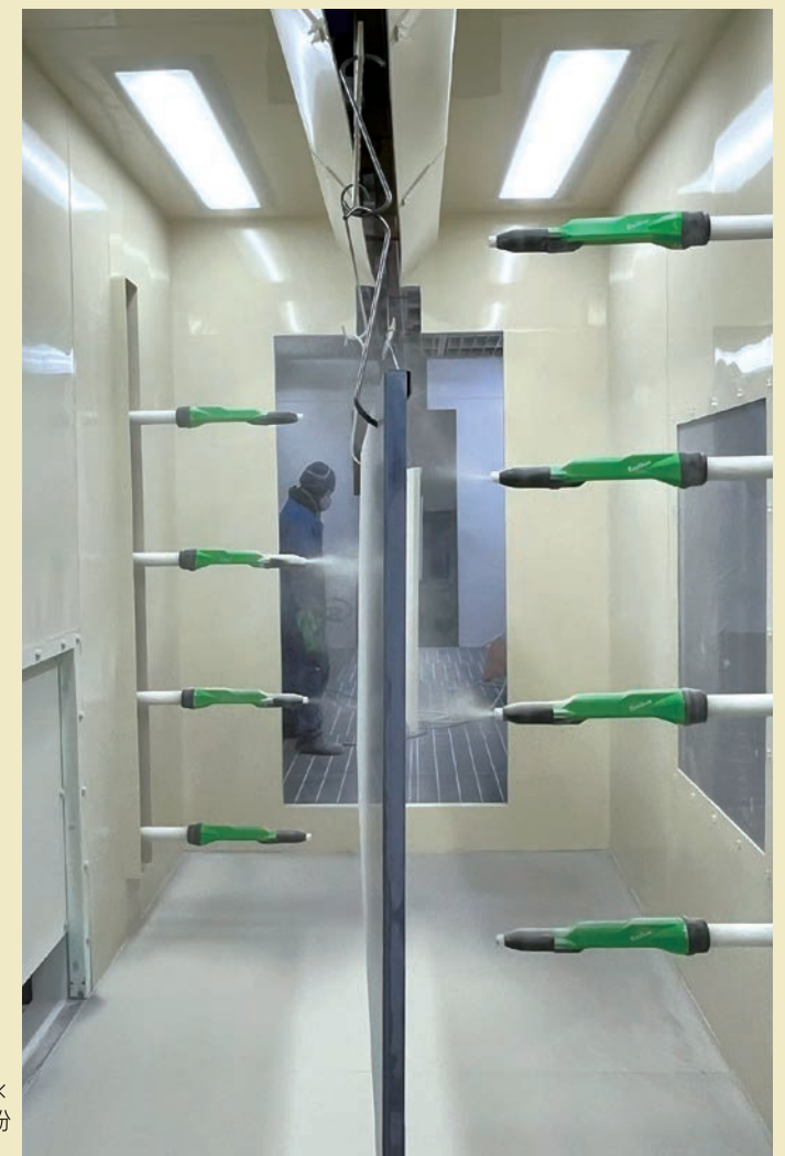
進行方向手前からエアブローブース、自動機ブース、手吹きブースが並ぶ
