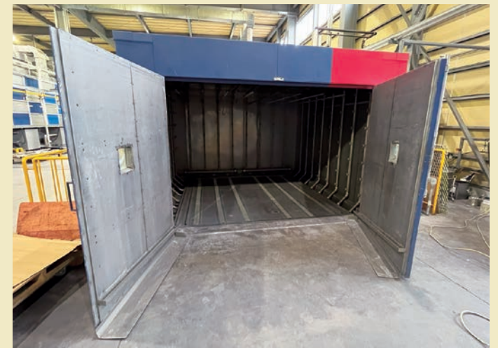
バッチ式の洗浄機ではリン酸鉄皮膜処理を実施
