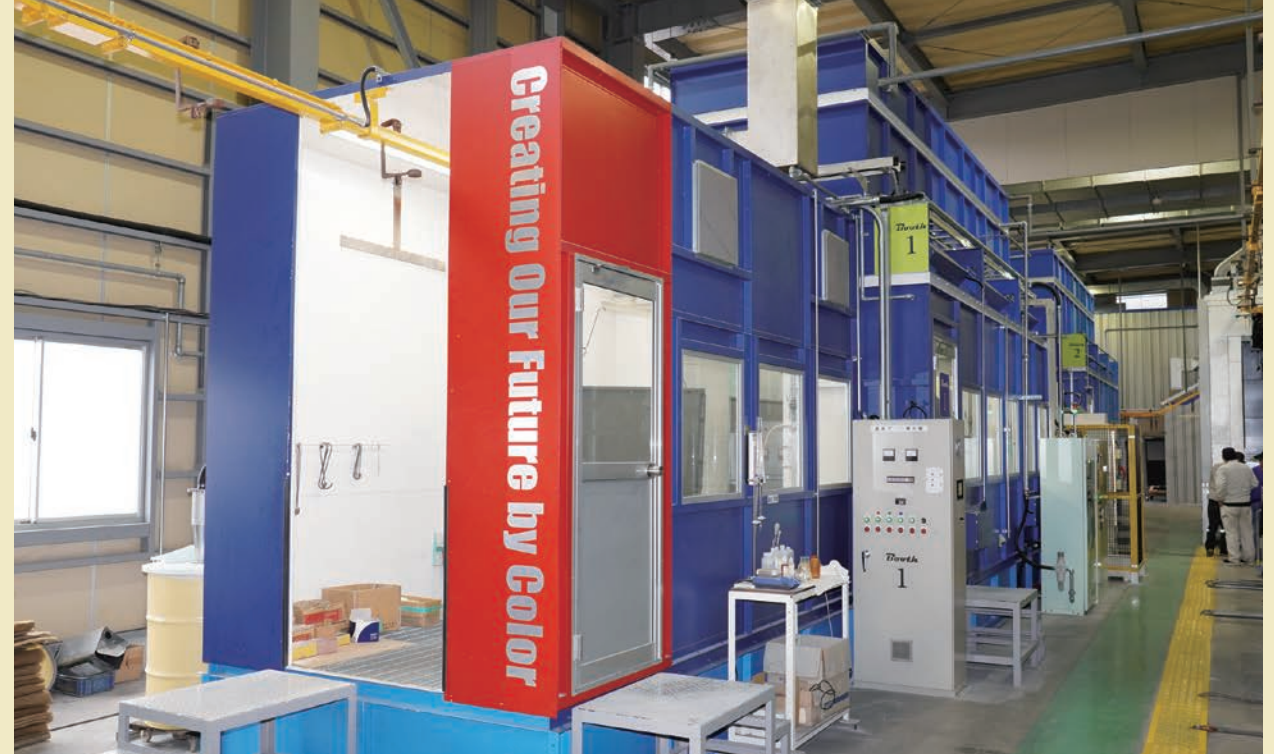
進行方向手前からエアブローブース、自動機ブース、手吹きブースが並ぶ
