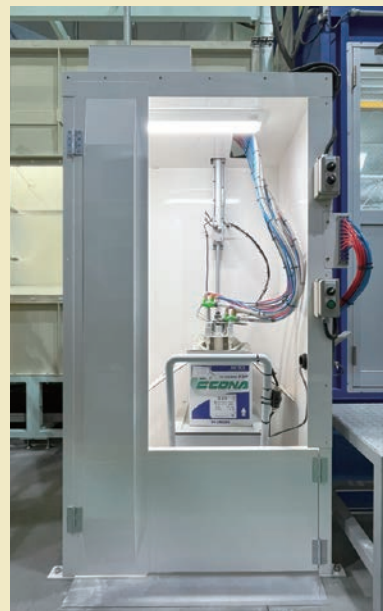
粉体塗料供給装置
