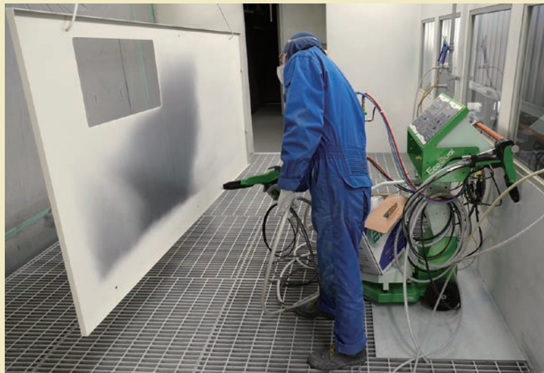
自動塗装後の補正および手吹き塗装にはデュアル電界方式静電粉体ハンドガンユニットEcoDual・AXR II 200DFを使用
