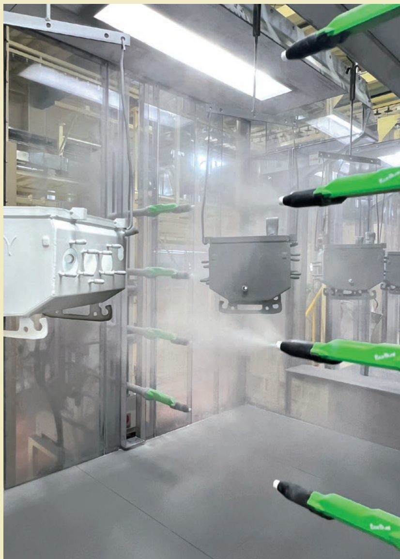
上塗りの粉体塗装システムは、1レシプロ4ガン(対面式/計8ガン)で、自動ガンはデュアル電界方式静電粉体自動ガンEcoDual・ECDaを装着する
