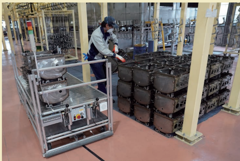
加工工場から自動搬送装置で 塗装工場にワークが運ばれる
