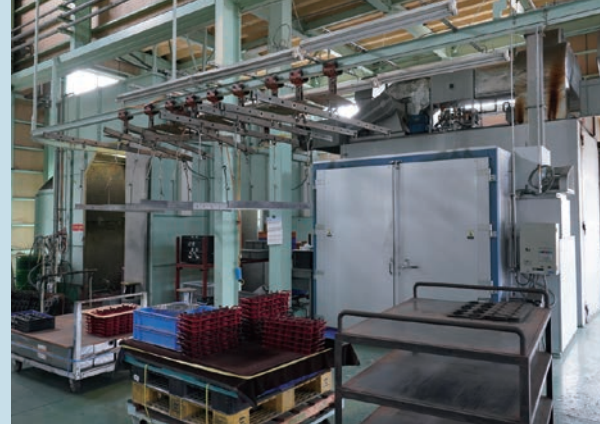
第3工場 大型物件用の塗装ライン (粉体・溶剤の手吹き塗装)
