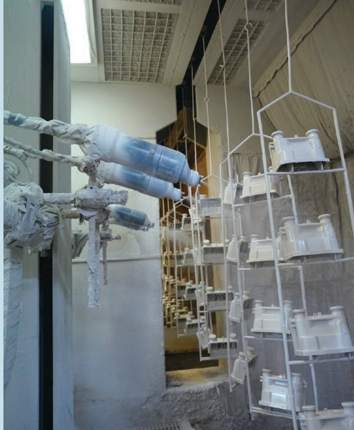
上塗り塗装 (下塗りと同じ塗装システム)
