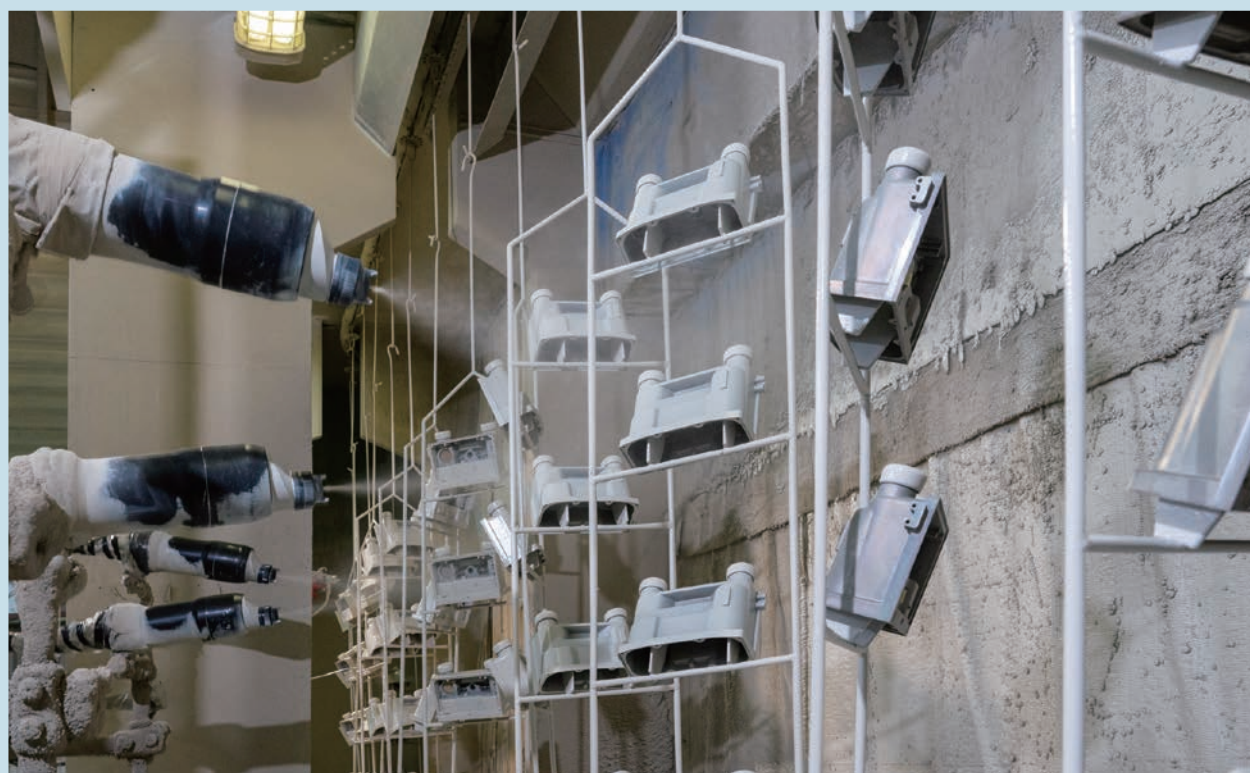
塗装（下・上塗り）は、エポキシおよびウレタン樹脂の二液塗装を実施する 塗装システムは、1レシプロ4ガン。自動ガンはエア静電自動ガン・サンガンⅢ（EAB500）を装着する
