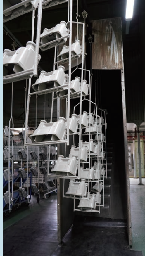
焼き付け乾燥炉入口
