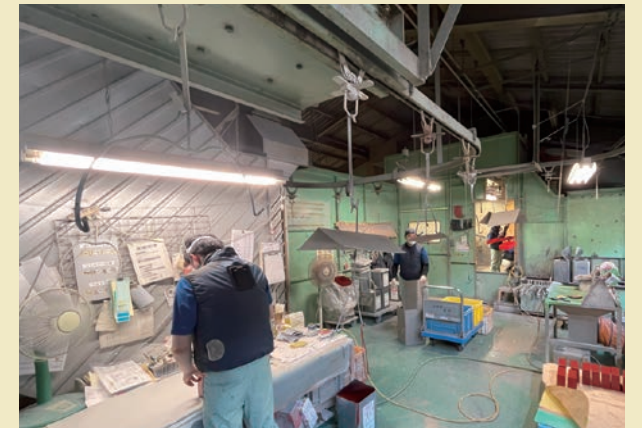
第2塗装班 溶剤塗装ライン(手吹き専用/小物ワーク中心)
