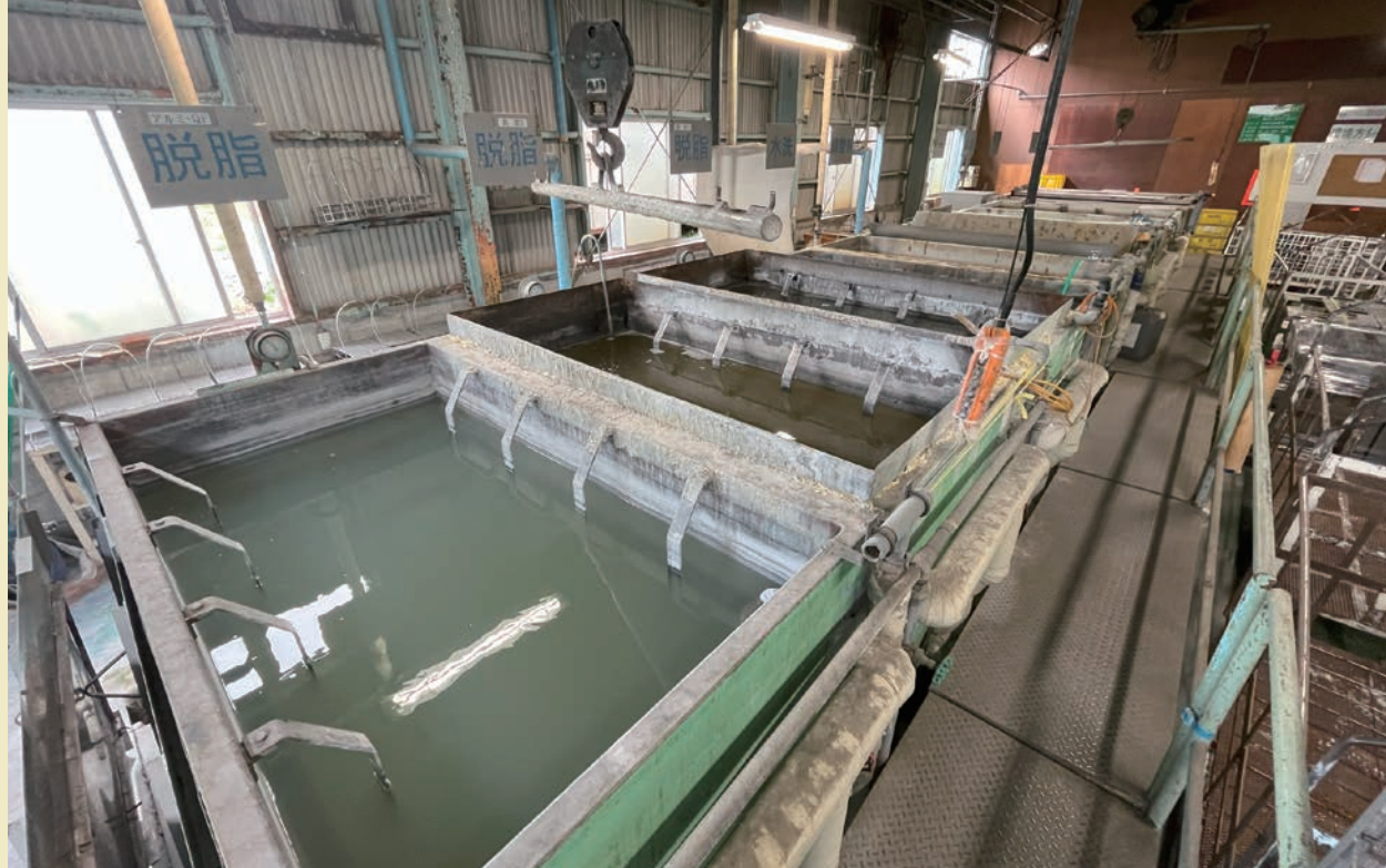
前処理装置（一般金属用：リン酸亜鉛化成処理、アルミ用：ジルコニウム化成処理）
