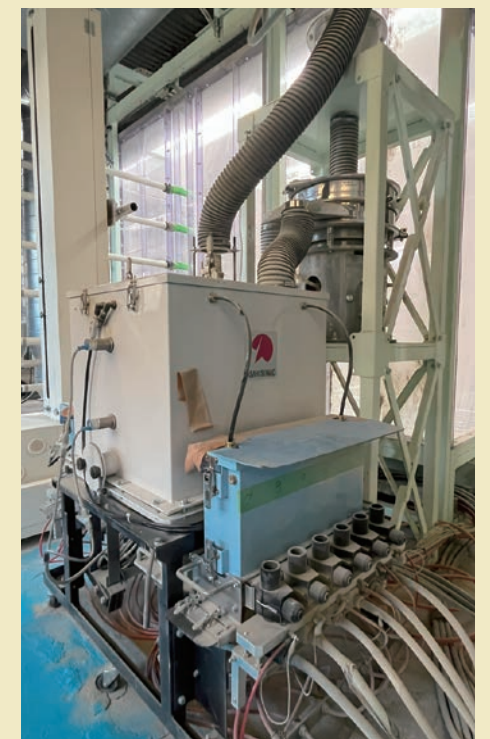
粉体塗料定量供給装置と振動ふるい機
