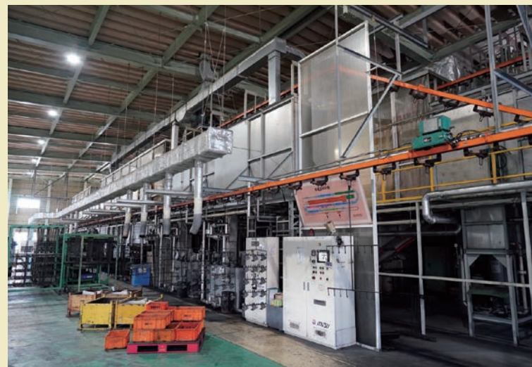
製造6課 前処理・電着塗装ライン(浸漬式/黒カチオン)
