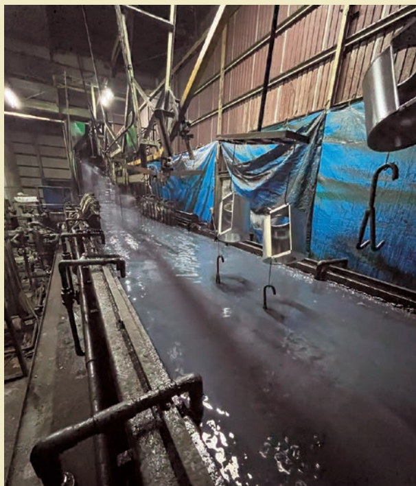
製造2課 前処理(シャワー式)・電着塗装ライン(黒カチオン)
