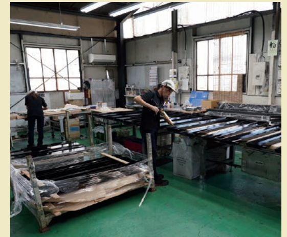
製造5課 断熱材やラバー等の組み付けを実施
