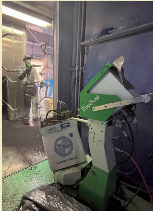
自動塗装後の補正および手吹き塗装には、デュアル電界方式 静電粉体ハンドガンユニットEcoDual・AXR II 200DFを使用
