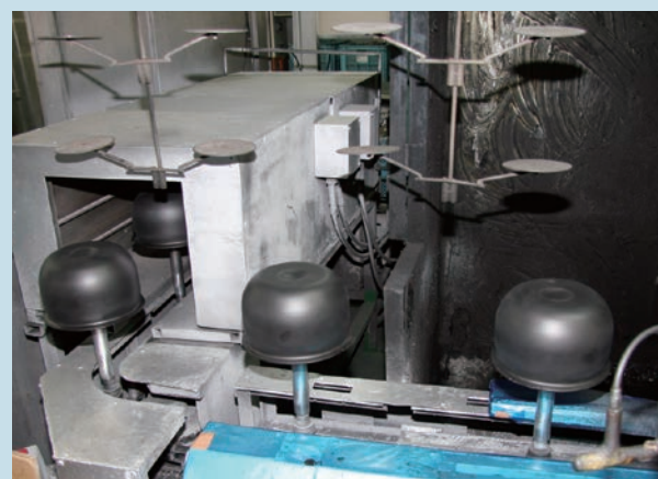
第二製造 電気炊飯器釜外面の耐熱塗装
