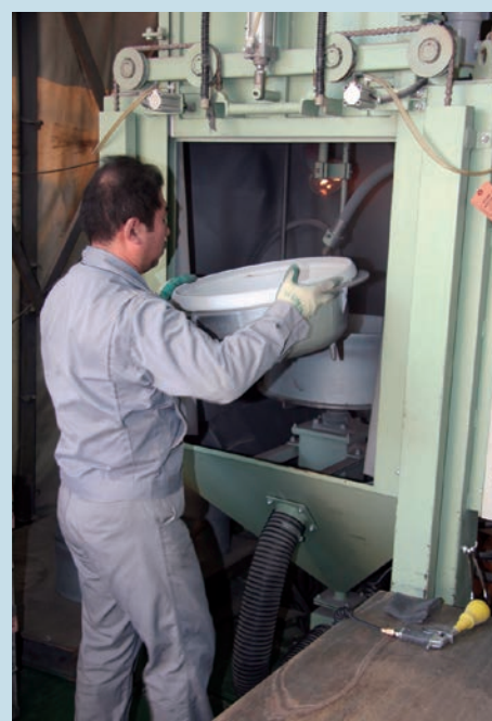
第三製造 電気炊飯器釜内面のサンドブラスト処理
