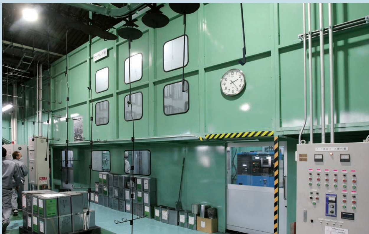
第一製造 塗装品質の向上、塗装不良の低減に大きく寄与するクリーンルーム
