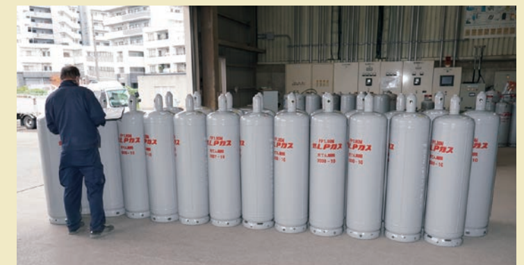
検査・再塗装を終えたLPガス容器
