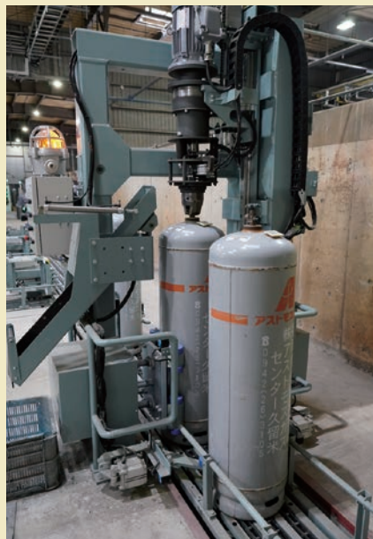
バルブの取り外し
