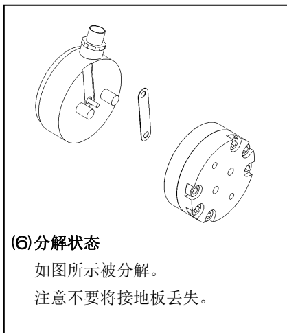
(5) 放大器的分解 取下固定螺丝钉(十字螺丝)， 从流量计本体上拆离放大器盒。
