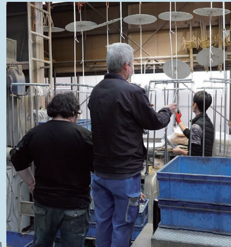
化成処理を終えたカーテンレール部品
