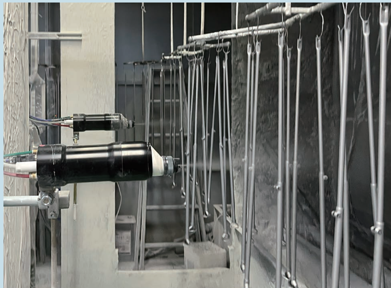
塗装システムは、1レシプロ2ガン、自動ガンはエア静電自動ガン・サンガンⅢ (EAB500) を装着
