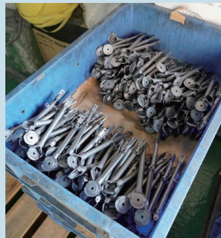
化成処理を終えたカーテンレール部品
