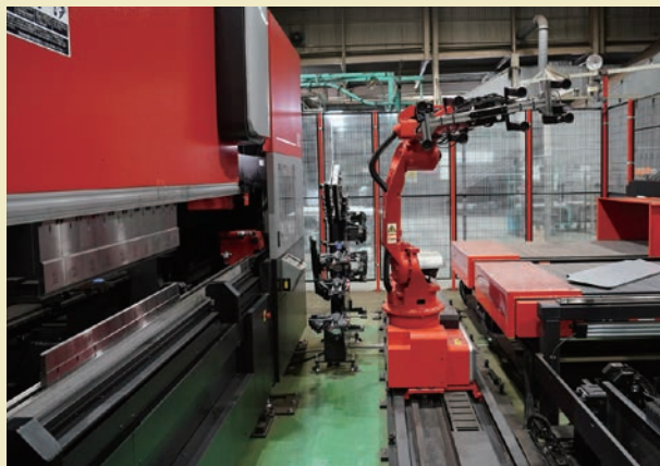
ベンディングロボットシステムで曲げ加工の自動化を図る
