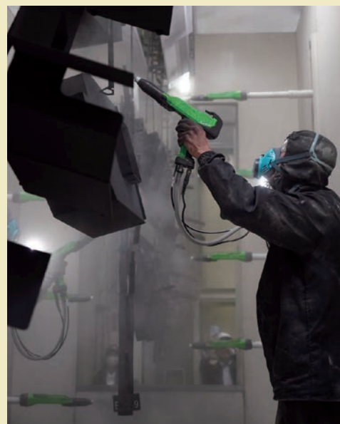
EcoDualハンドガンユニットによる補正塗装
