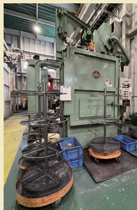
ショットブラストによる塗装ジグ剥離
