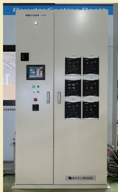
粉体自動ガン制御盤
