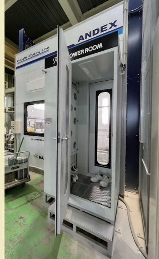
補正ブース出入口のエアシャワーブース
