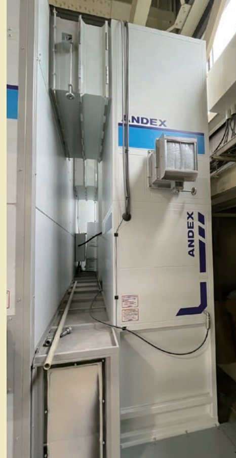
本塗装システムのカギとなる 高性能集塵装置「ADC」(アンデックス(株)製)
