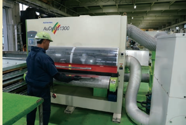
切断加工後のバリ取り
