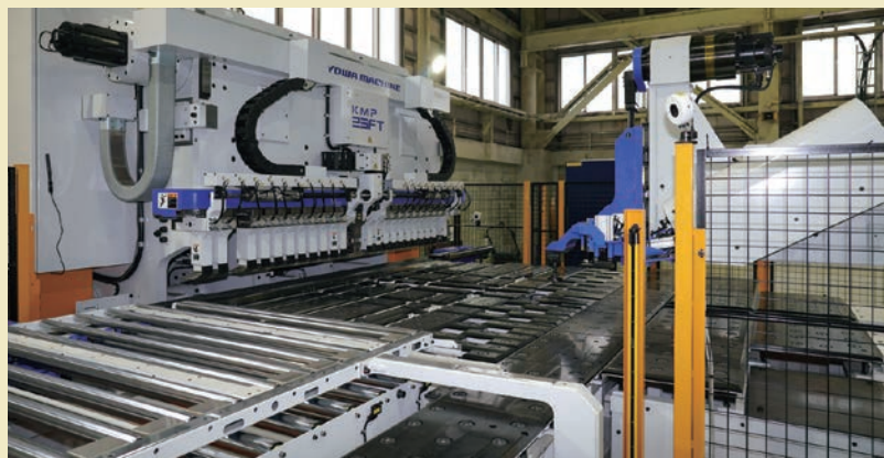
生産性向上と省人化を実現する最新の自動ベンディング装置
